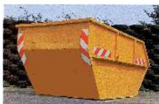
Container und Wechselbehälter müssen mit Warnstreifen aus Folie Typ 2 nach DIN 675 20 Teil 2, Farbe gemäß DIN 6171, gekennzeichnet werden.
