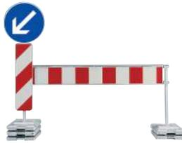
Die Absperrschranken und Richtungstafeln aus sendzimirverzinktem Blech oder aus Aluminium sind doppelt abgekantet und mit angenieteten Einhängebügeln aus Vierkantstahl versehen. Sie besitzen eine Standardlochung zur Befestigung von Verkehrssicherungs-Leuchten und sind gut stapelbar.
