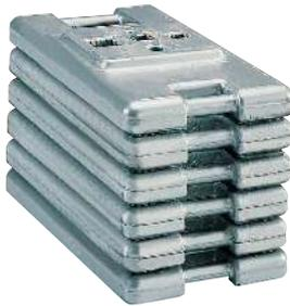
Aus umweltfreundlichem Recyclingmaterial. Beliebig stapelbar. Fläche und allseitig abgerundete Form. Ausgelegt für eine Windlast von 420 N/qm. Öffnungen zur Aufnahme von Batterien für Bakenleuchten (160 x 160 mm), Vierkantrohren (60 x 60 mm und 40 x 40 mm), 2 Rundrohren Ø 42 mm für mobile Absturzsicherungen und Sicherheitsstandrohren (45 x 40 mm). Funktionsgerechte Tragegriffe in den Stirnseiten integriert. Gewicht ca. 29 kg. Abmessungen: 800 x 400 x 100 mm.
