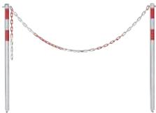
Mit zwei roten, refl. Ringen. Bestehend aus Stahlrohrpfosten Ø 60 mm, 1500 mm lang, feuerverzinkt. Angeschweißte Deckelklappe, Bodenanker und zwei Kettenösen.
