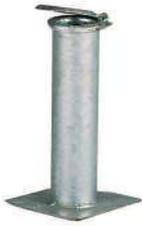
Für Absperrpfosten APH. Aus Stahlrohr, 300 mm lang, feuerverzinkt. Mit angeschweißtem Bodenblech, Verschleißzapfen und Schutzdeckel.
